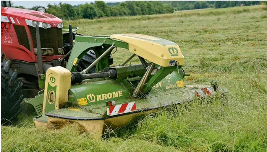
Prevedenie Pull – ťahaná verzia, hydropneumatické nastavenie prítlaku lišty-sériovo
